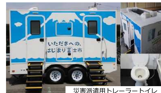
災害派遣用トレーラートイレ
